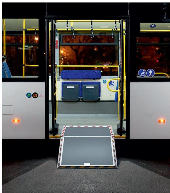
Рис. 1. Аппарель откидная с ручным приводом
